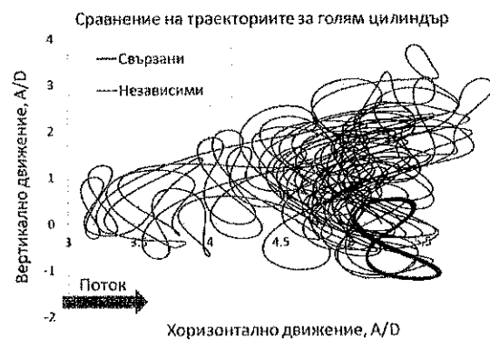
Фигура 3. Повишение на ефективността на системата и сравнение на траекторията на независим (в червено) и еластично свързан цилиндър (в черно). Движенията тук са обезразмерени с диаметъра на цилиндъра D .
