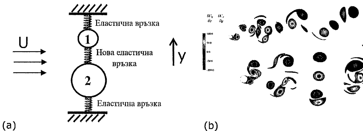
Фигура 2. Схематична постановка на задачата с два цилиндъра и компютърна (CFD) симулация на откъсваните вихри
